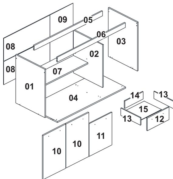
01 - Fixar a base, laterais, divisória e ripas com parafusos **D** e cavilhas **A**, em seguida fixar as corrediças **K** com parafusos **E** na lateral direita e divisória.
