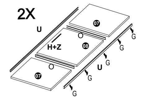
Montagem do deslizador superior no topo da porta
