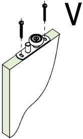
Instalação do deslizador inferior na porta
