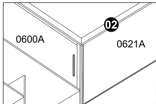
Na montagem conjunta com a ponte **0600A** o Roda-forro (**02**) deverá sempre ser cortado pelo montador para um correto encaixe.
