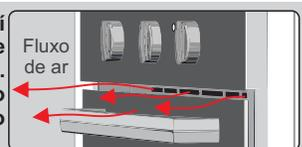
**Atenção:** Mesmo após o termino do assado e do tempo programado, o sistema de resfriamento continua funcionando, o ar quente continua sendo soprado para fora do forno até que o produto se resfrie, desligando-se automaticamente;
