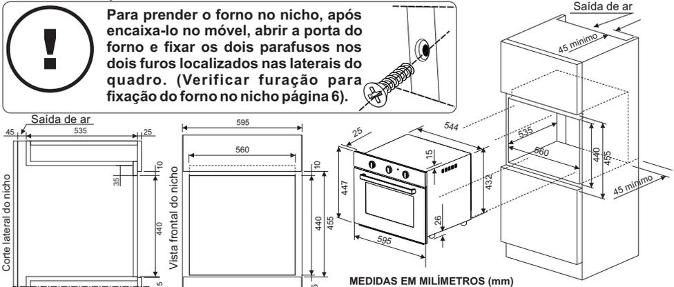
Para garantir o bom funcionamento do forno elétrico Fischer, é necessário que o nicho de embutimento tenha abertura para saída de ar quente.
